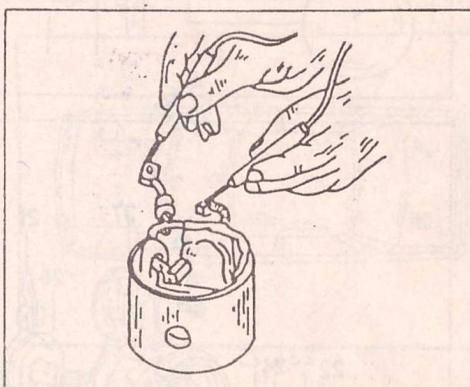
Рис. 282. Проверка щеток стартера на отсутствие обрыва цепи.
